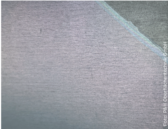
Abb. 1: Mit SurTec 650 passiviertes Aluminiumblech. Großer Bereich mit SurTec 650, kleiner Bereich ohne SurTec 650
