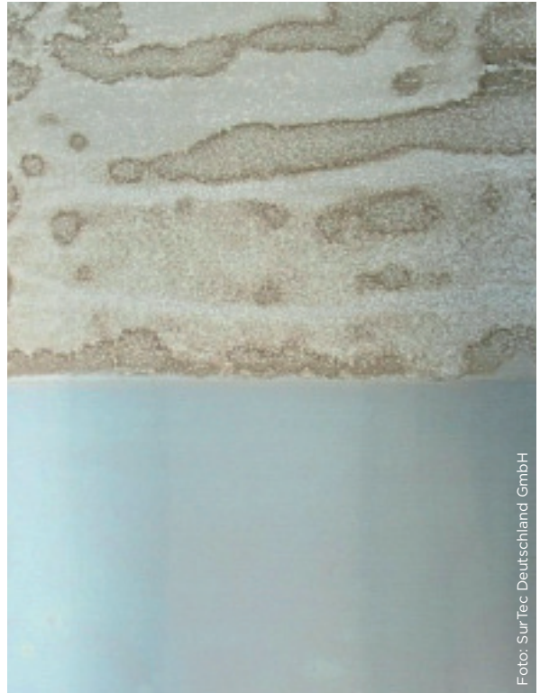
Abb. 2: Obere Hälfte unbeschichtet, untere Hälfte SurTec 650 passiviert. Nach 168 Stunden NSS (Neutraler Salzsprühtest, ASTM B-117 bzw. DIN EN ISO 9227)
