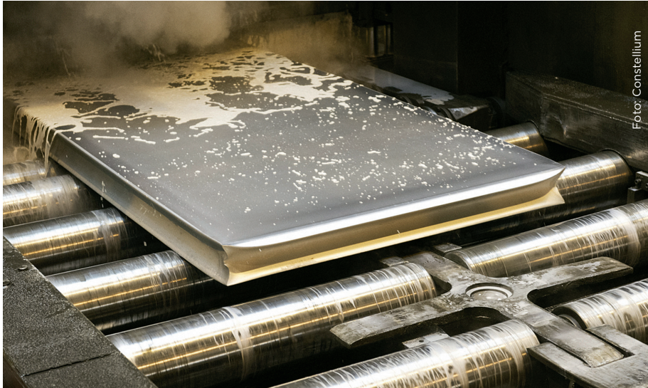
Abb. 1: Walzbarren in Produktion
